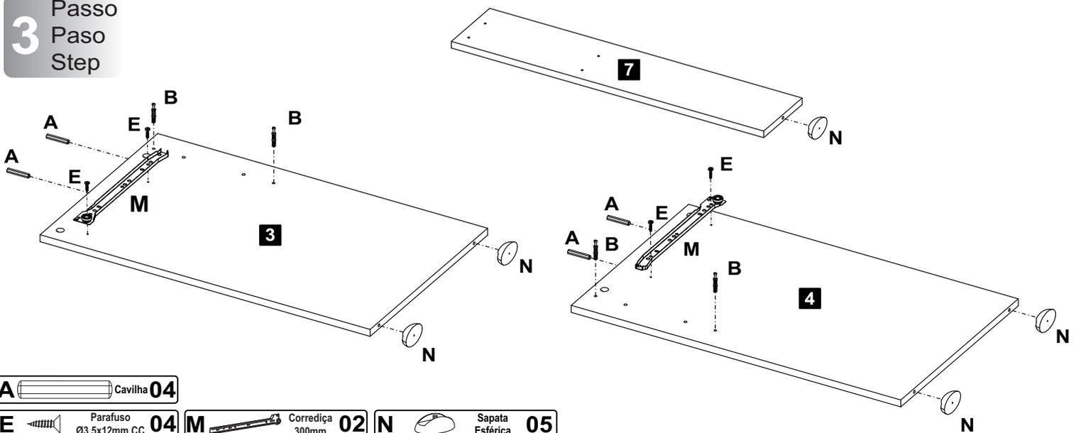
**A** Cavilha 04 **E** Parafuso Ø3,5x12mm CC 04 **M** Corrediça 300mm 02 **N** Sapata Esférica 05
