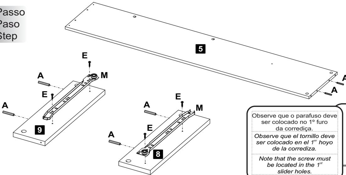
**A** Cavilha 06 **E** Parafuso Ø3,5x12mm CC 04 **M** Corrediça 300mm 02
