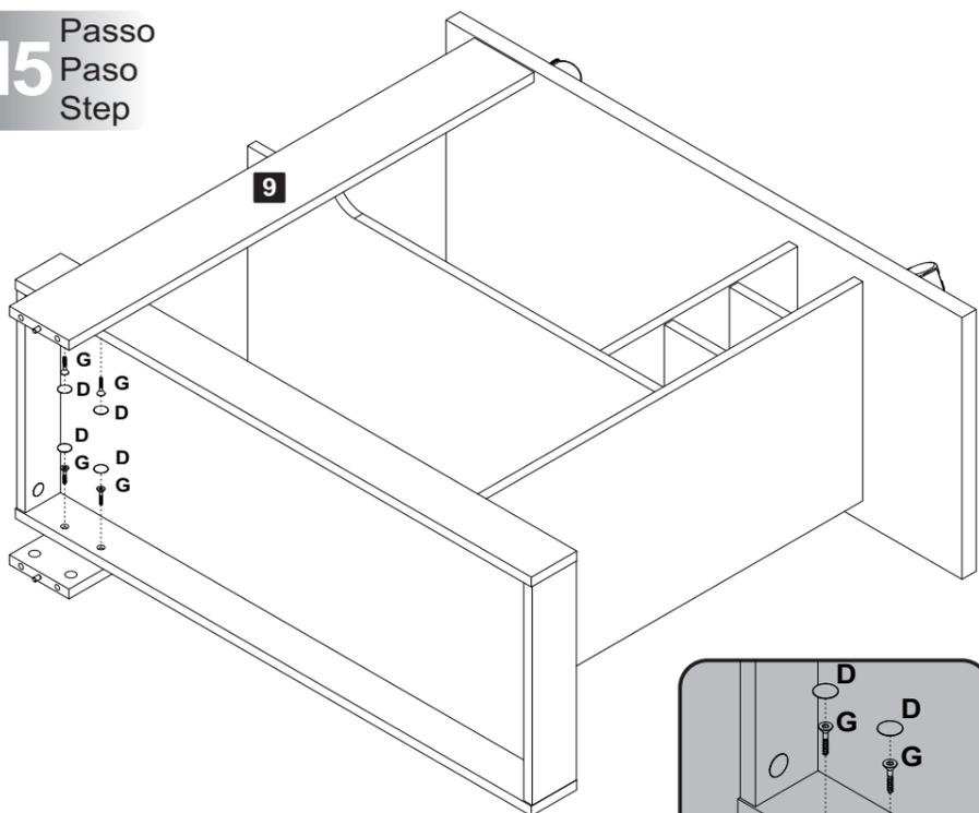
D Tapa Furo Adesivo 04 G Parafuso Ø5,0x24mm 04
