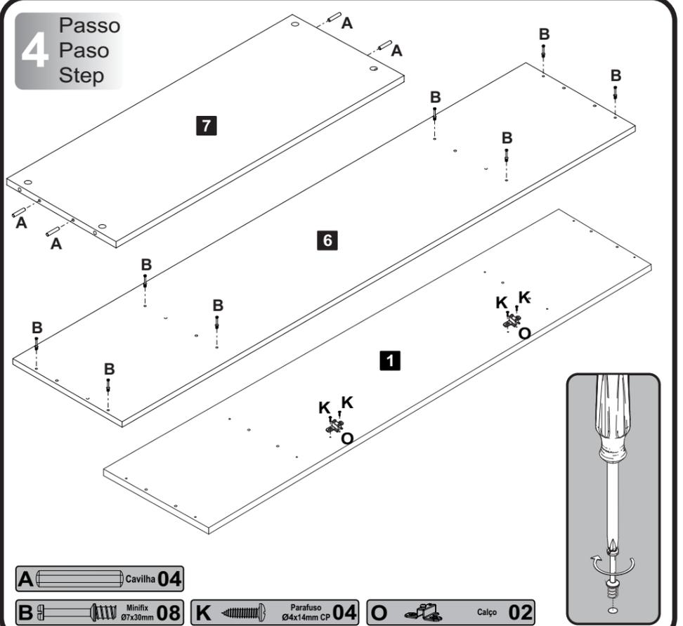
**A** Cavilha 04 **B** Minifix 07x30mm **K** Parafuso 04x14mm CP **O** Calço 02
